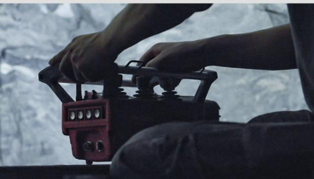
Mando a distancia eléctrico proporcional hidráulico sistema de control inteligente, no hay puntos ciegos en el campo de visión durante el funcionamiento, el personal se mantiene alejado de Ajuste visual de los parámetros de funcionamiento, que puede ser pre-diseñado para responder con flexibilidad a las diferentes condiciones de trabajo.
